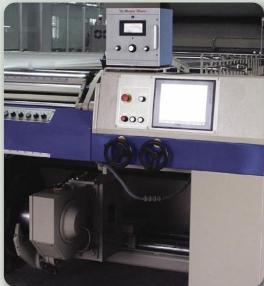
T-MDSコンピュータ制御装置は、TTS10Sを総合的に制御・運転管理します。タッチキー操作とカラーグラフィック表示で、容易な操作とトラブルシューティングによる迅速な故障対応が可能です。T-MDSの自動条件設定機能は、T-Tech Japanのノウハウから推奨する糊付条件設定を簡単な操作で画面に表示します。
