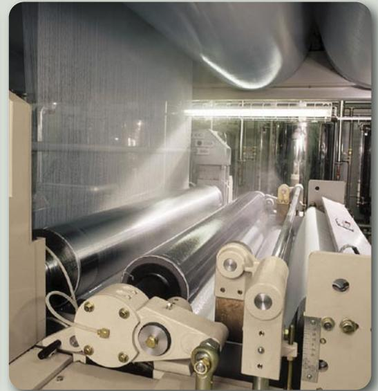
糊液は2つのサイズボックス間で循環し混合されますので、糊液濃度および粘度は均一となり、それぞれのボックスを通過する糸シートの着糊量が均一になります。
